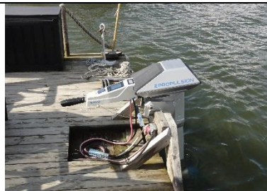
Badflotten drivs med en 3 kW elektrisk utombordare. Men 1 kW räcker för stilla färd i Mälaren.
