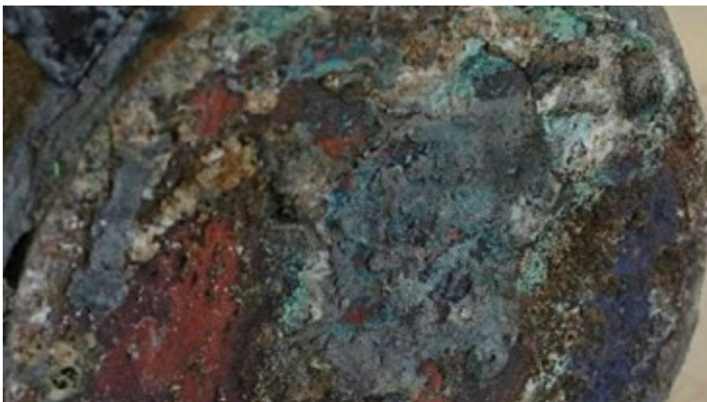
Korroderat koppar från LOT-försök 20 år.
